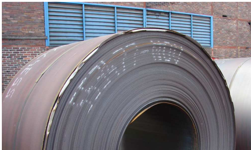
Abbildung 5.1: Ein warmgewalztes Stahlcoil mit deformierten Außenwindungen aufgrund eines Transportschadens [vSGa]
