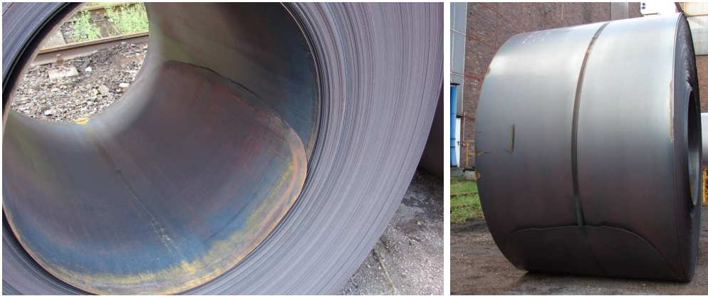
Abbildung 1.5: Ein warmgewalztes Coil, dessen Kopf und Fuß noch nicht abgeschrottet wurde. Das Bandende (rechts) ist stärker deformiert als der Bandanfang (links). [vSGa]
