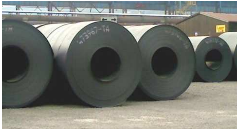
Abbildung 1.3: Nummerierte Stahlcoils im Freilager [Bac08]
